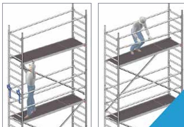
3. Installez les diagonales et la plate-forme suivante.
