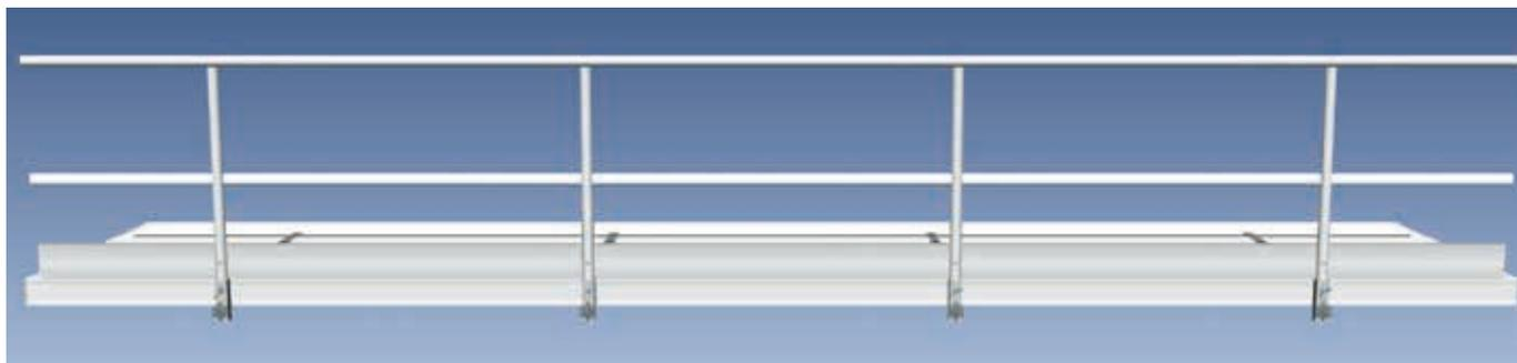
La charge répartie sur les passerelles de 60cm de largeur est  $2\text{kN/m}^2$  jusqu'à 7.10m. La charge répartie sur les passerelles de 8.0m, 9.1m et 10.0m est  $1.5\text{kN/m}^2$ . Pour la largeur de 90cm la charge répartie est de  $1.5\text{kN/m}^2$ . Pour tous les passerelles la charge concentrée est de  $1.5\text{kN}$  et l'appui minimal est 25cm.
