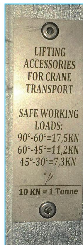
Plaque d'instructions avec indiquant la charge sur les différents positions des angles de préhension.
