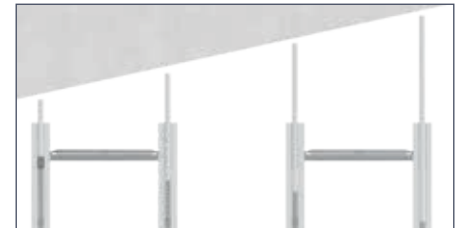
Met de tussendragers kunnen de randzones gemakkelijk worden aangepast dankzij verschillende uitschuiflengtes
